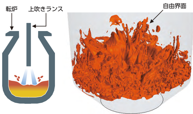
転炉上吹きジェットによる自由界面変形挙動の解析例
